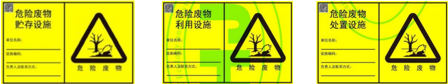
图 5-1 危险废物贮存、利用、处置设施标志样式示意图
