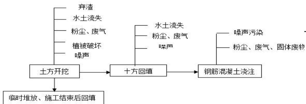
**图 2-3 建筑物工程工艺流程及产污环节**
