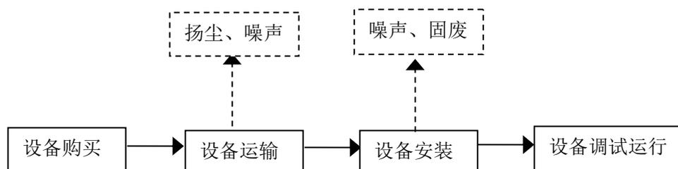
图 2 施工期工艺流程及产污环节图
