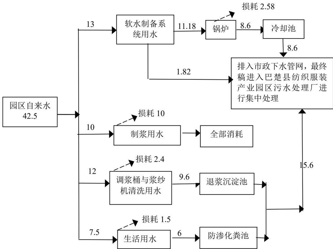
图1 水平衡图 (单位: m³/d或m³/次)
