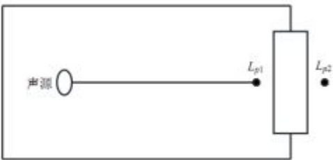
图 4-1 室内声源等效为室外声源图
