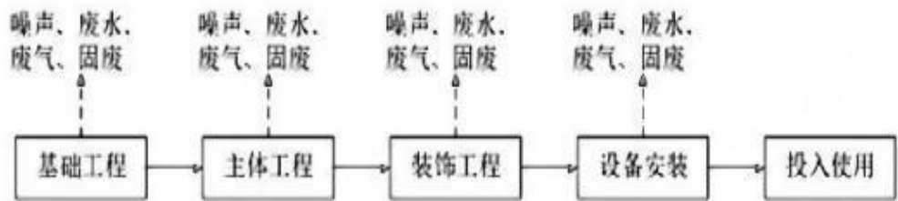
图 2-2 施工期工艺流程及产污环节示意图
