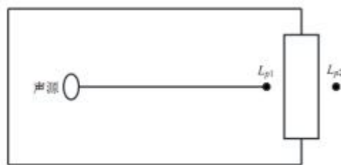
图 4-2 室内声源等效为室外声源图
