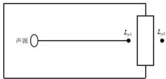
图 4-2 室内声源等效为室外声源图例
