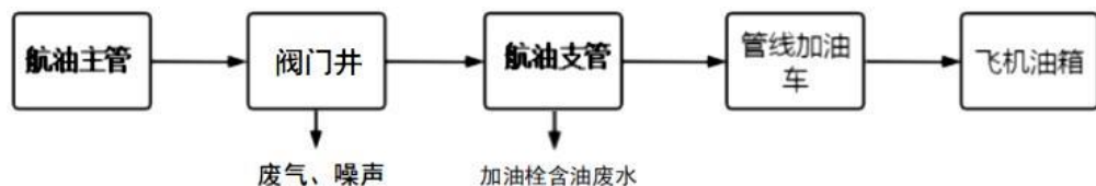
图7 生产工艺流程及产排污节点图
