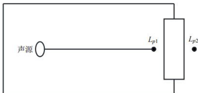
图 4-1 室内声源等效为室外声源图例
